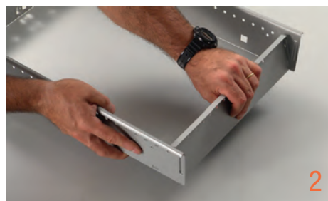
Sollevare le parti corte Fold short sides
