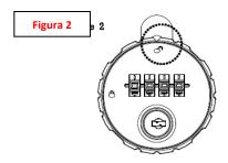
2. Inserire una chiavetta all'interno del foro per la modifica password e ruotarla come mostrato in Figura 3
