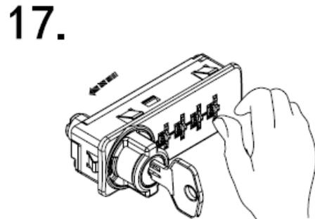
Ruotare le rotelle una alla volta fino a quando si bloccano
